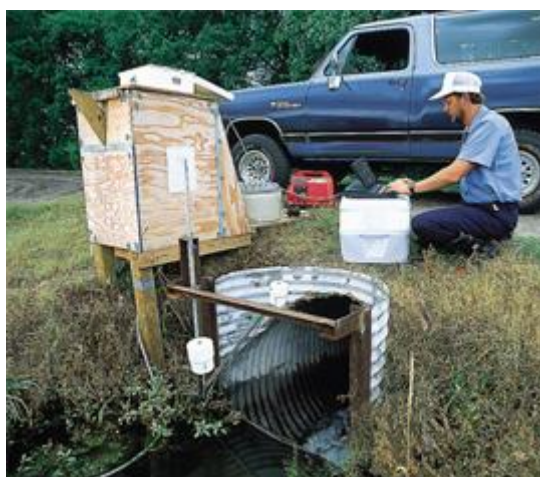
写真提供：MACTEC 社。雨水排水管の集水位置近くで得られた水質標本の調査
